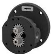
La bomba de engranajes externos consta de dos ruedas dentadas engranadas. Una de las ruedas dentadas se acciona mediante un eje. El segundo engranaje (el engranaje loco o intermedio) se mueve accionado por el dentado. Con las ruedas engranadas, el espacio entre dos dientes se cierra con el diente opuesto. Cuando un diente sale del espacio entre dientes, se genera una presión negativa. Este espacio libre aspira aceite.
